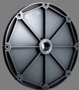
На этой основе RF-K разработала крутильно-жесткую, но радиально-упругую муфту, которая используется в гидронасосах с фланцевой установкой для регулировки собственной частоты валопровода, чтобы оборудование могло работать на собственной частоте и избежать крутильного резонанса.
