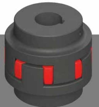
Изогнутая кулачковая муфта серии CJ-E, специально разработанная для гидравлической системы, компрессионного типа, по сравнению с зубчатой муфтой барабанного типа с нейлоновой втулкой, может обеспечить больший крутящий момент и может эффективно смягчить удар и уменьшить вибрацию, обеспечивая при этом осевую, угловую и радиальную компенсацию. Обладая очень высоким соотношением цены и качества, это идеальный выбор для трансмиссии гидравлической системы.
