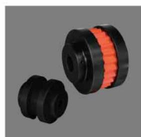
Муфты серии S-Flex выпускаются в полном диапазоне размеров от 3 до 16, с максимальным крутящим моментом 8189 Нм и максимальным отверстием 152 мм Стандартная ступица изготовлена из чугуна Тип промежуточного сегмента может использоваться для замены эластомера без перемещение приводного и погружочного оборудования Подходит для нестационарной работы ударного/вибрационного оборудования, такого как насосы, компрессоры, вентиляторы, смесители и т. д.
